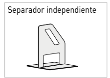
6 Separador independiente: Chapa de acero plegada de espesor 2 mm con pie de apoyo integrado. Dimensiones 23x16 cm
